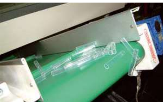
Fabrication des tubes en polypropylène pour la seringue Soficoncept
