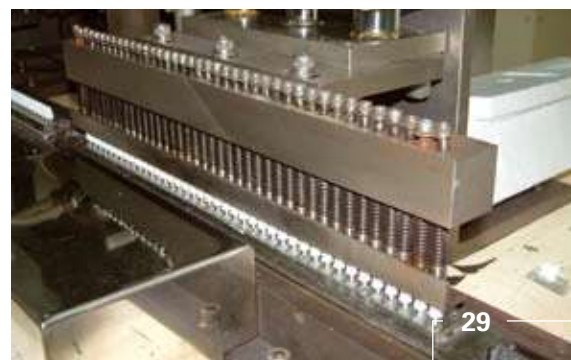
Les aiguilles métalliques sont insérées sur leurs embases
