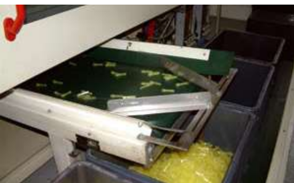
Fabrication des capuchons pour aiguilles Sofiject
