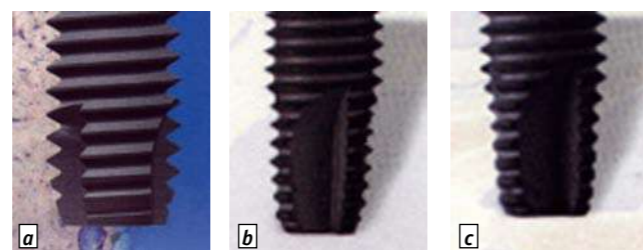
Fig.18a, b et c. L'extrémité autotaraudante de la plupart des systèmes implantaires (ici : NobelBiocare, AstraTech, 3i) a été sablée et/ou mordancée, ce qui est une ineptie mécanique et favorise l'échauffement lors de la mise en place par vissage autotaraudant de l'implant.
