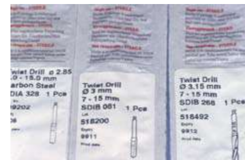
Fig.22. Le système NobelBiocare propose, pour l'implant de 3,75 mm de diamètre, 3 forets terminaux : 2,85 mm pour l'os de type IV, 3 mm pour l'os de type II ou III et 3,15 mm pour l'os de type I.
