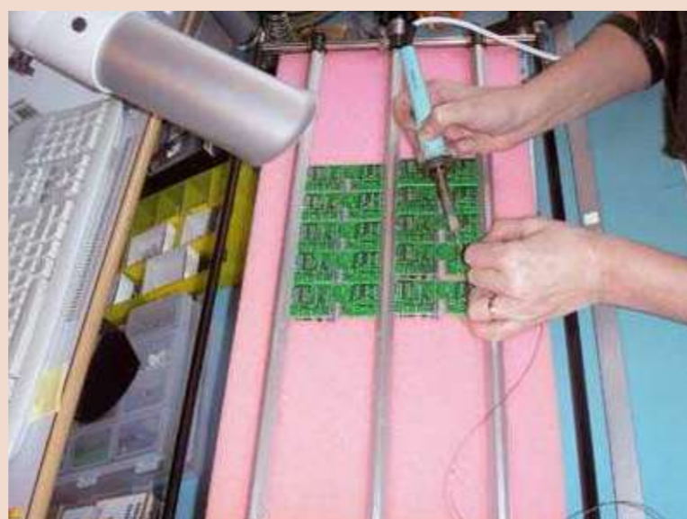
Montage manuel des composants électroniques
