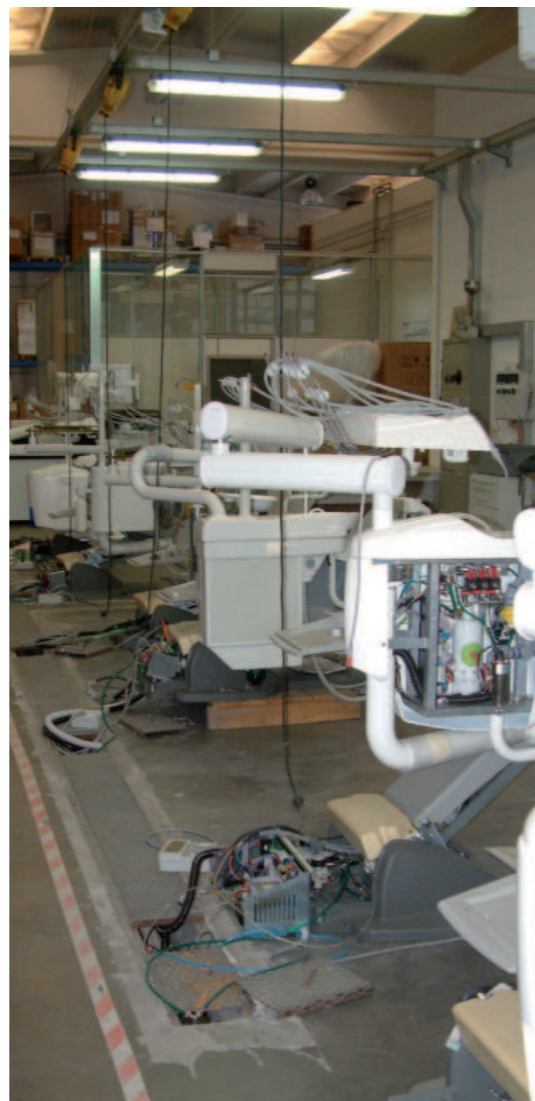
Les units passent ici leur examen de conformité ! Durant 24 heures, tout est contrôlé : eau, air, évacuation, électronique, alimentation...
